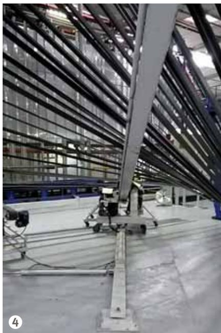
Figura 4: Soluzione per lo scarico automatico delle barre corte.
